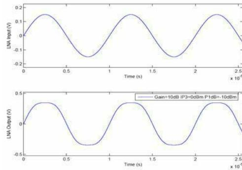
Fig.7. LNA nonlinearity simulation
