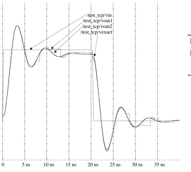
PInput siganl - vin POutput signal vout < vout1 : M = 3 < vout2 : M = 10
