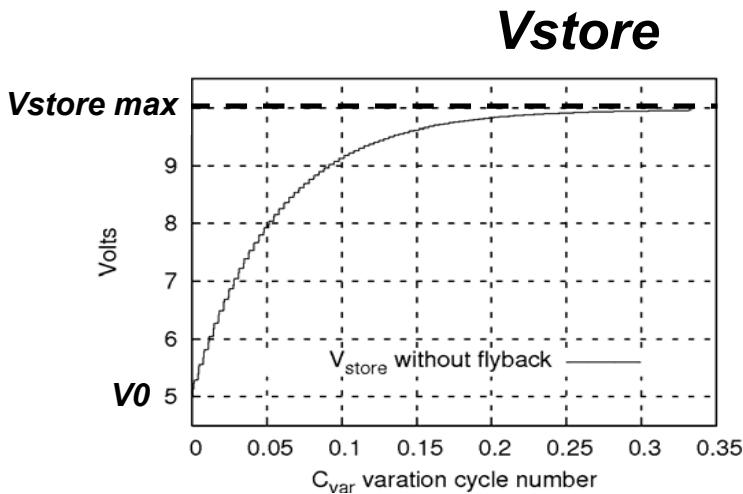
$$V_{store \ max} = V_0 C_{max} / C_{min}$$
